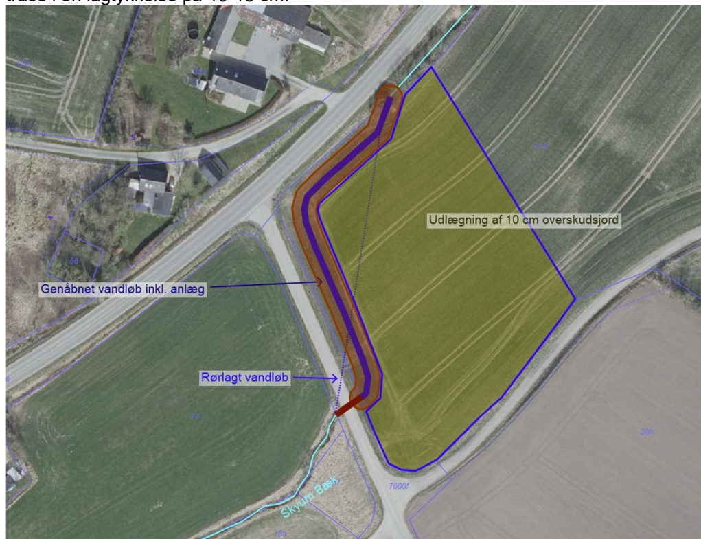
Udlægning af overskudsjord.
