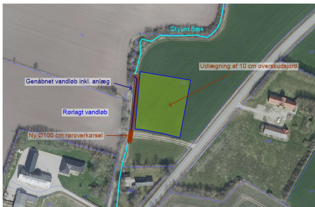
Udlægning af overskudsjord.
